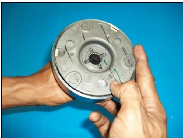
15. ประกอบชุดคลัตช์แรงเหวี่ยงเข้ากับ เรือนคลัตช์ตัวนอกชั่วคราวหมุนต้นกำลัง ขับตัวนอกและตรวจเช็คการทำงานของ คลัตช์ทางเดียว พร้อมทั้งตรวจเช็คให้ แน่ใจว่าต้นกำลังขับตัวนอกหมุนตามเข็มนาฬิกาเท่านั้นและไม่หมุนทวนเข็มนาฬิกา
