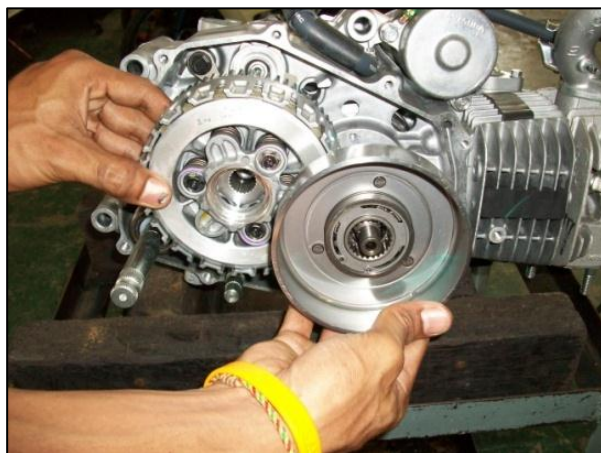
14. ถอดเรือนคลัตช์แรงเหวี่ยงตัวนอกและ คลัตช์กลไกออกพร้อมกันทั้งคู่
