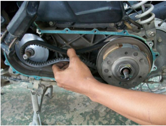
13. ประกอบพูลเลย์ขับเข้ากับเพลาค้อ เหวี่ยงและพูลเลย์ตามเข้ากับเพลาล้อ
