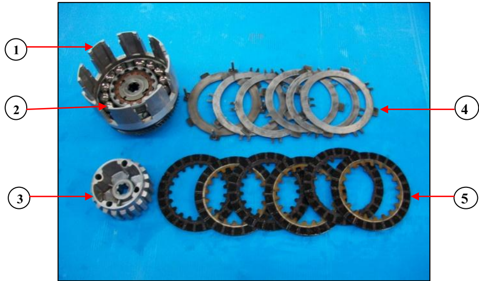
1. เสื้อคลัตช์ 2. ลูกปืนเหวี่ยง 3. คุมคลัตช์ 4. แผ่นเหล็ก 5. แผ่นผ้าคลัตช์
