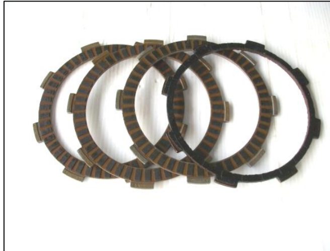
รูปที่ 7-5 แสดงแผ่นฝักคลัตช์ (Clutch Plate)
